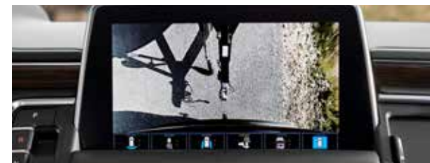
Vue de l'attelage Permet d'avoir une vue rapprochée de l'attelage pour faciliter l'alignement lors de la connexion à une remorque.
