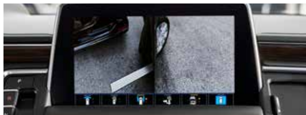
Vue latérale avant Affiche la position des pneus avant pendant le stationnement et les manœuvres serrées.
