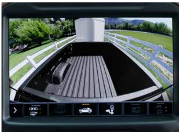
Vue de caisse Permet de voir la caisse pour faciliter l'accrochage de la sellette d'attelage ou de l'attelage en col de cygne ou pour brièvement surveiller le chargement.
