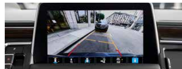
Vue de caméra arrière Affiche la vue de caméra arrière pour faciliter le stationnement et les manœuvres serrées.
