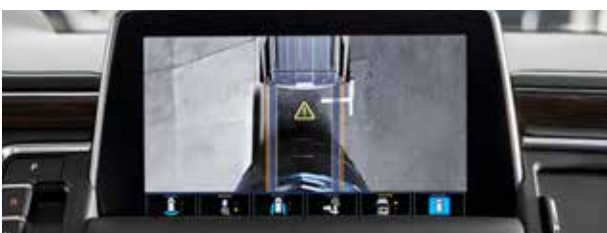
Vue verticale arrière Montre le dégagement entre l'arrière du véhicule et les objets à proximité.
