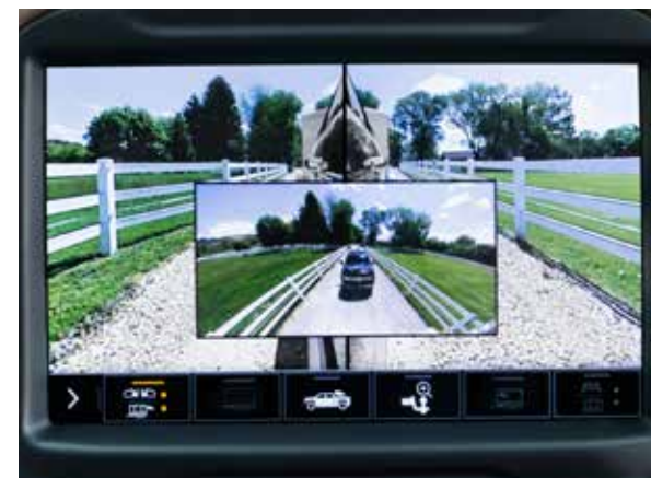
Vue latérale image à image 1 Combine deux vues – la vue latérale arrière et la vue arrière de la remorque. Nécessite la caméra Accessoires Chevrolet livrable en option.
