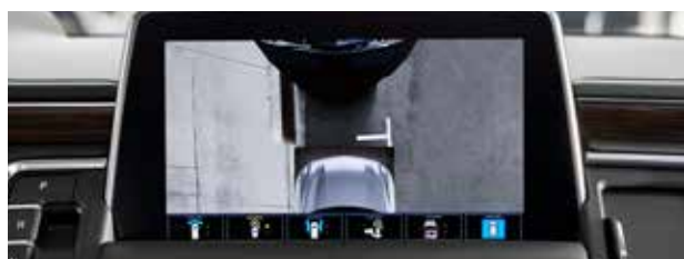
Vue d'en haut Vue d'en haut du capot, du pare-chocs et des pneus avant pour les manœuvres serrées dans les stationnements ou le long des trottoirs.
